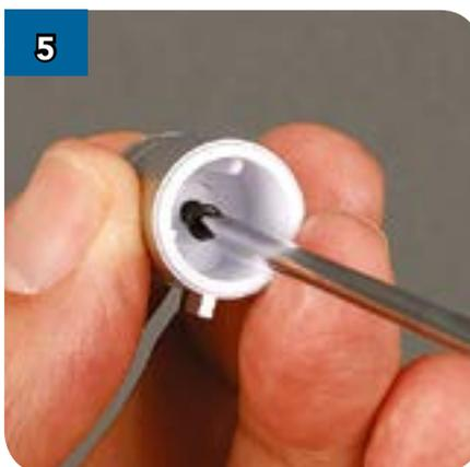
5 ...закрепите её, вкрутив саморез с обратной стороны в крепёжное отверстие.
